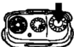
Поворачивайте регулятор громкости по часовой стрелке, чтобы увеличить громкость. Поворачивайте регулятор громкости против часовой стрелки, чтобы уменьшить громкость.
