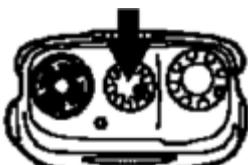
Поворачивайте селектор каналов, чтобы выбрать желаемый канал (с 1-го по 16-й).
