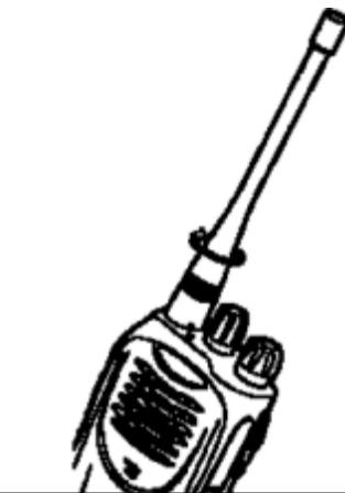
Совместите резьбу антенны с антенным разъемом. Заверните антенну по часовой стрелке до упора. Чтобы снять антенну, вращайте ее против часовой стрелки.
